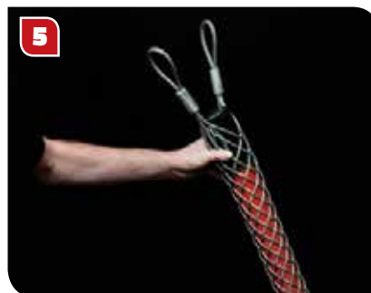
5 Grepet må da skyves langs kabelen slik at hele gitteret er i kontakt med kabelen.
