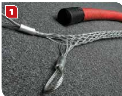
1 Start snøringen fra "øye"-enden eller forankringsenden av kabelgrepet.
